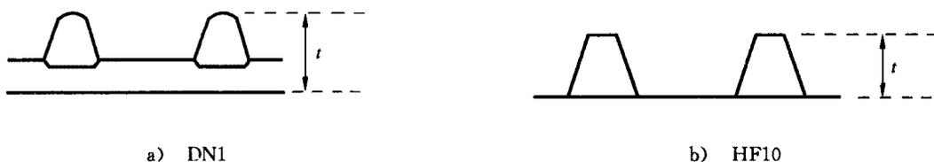
图 3 DN1、HF10 厚度的测量部位
